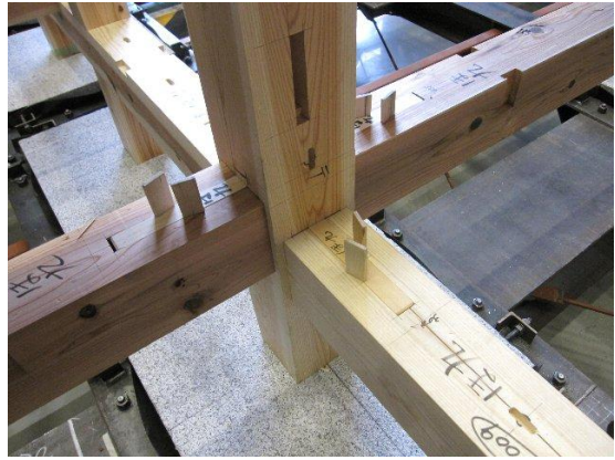
1 階中柱足固め接合部
